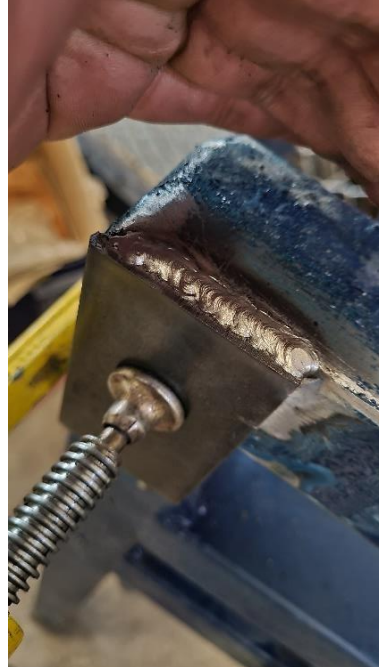
ILUSTRACIÓN 8: ELABORACIÓN DEL CHASIS DEL VEHÍCULO-GRÚA MEDIANTE LE PROCESO DE FABRICACIÓN CON SOLDADURA DE ELECTRODO 6013 3/32.
