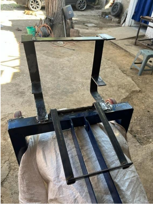
ILUSTRACIÓN 8: ELABORACIÓN DEL CHASIS DEL VEHÍCULO-GRÚA MEDIANTE LE PROCESO DE FABRICACIÓN CON SOLDADURA DE ELECTRODO 6013 3/32.
